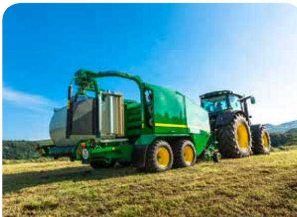
**Immagine 4:** La fasciatura deve esitare in 3-4 strati di film plastico a copertura del ballore per evitare l'infiltrazione di aria e la degradazione del foraggio umido.
