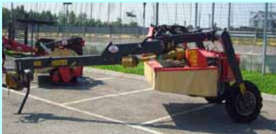
FALCIACONDIZIONATRICE VICON KMR 2401 - REGOLAZIONE CENTRALIZZATA ALTEZZA TAGLIO - CONDIZIONATORE A 2 RULLI GOMMA - LARGHEZZA DI LAVORO MT 2,4 - 6 DISCHI e 18 COLTELLI PREZZO 14.500 € NO PERMUTE USATO
